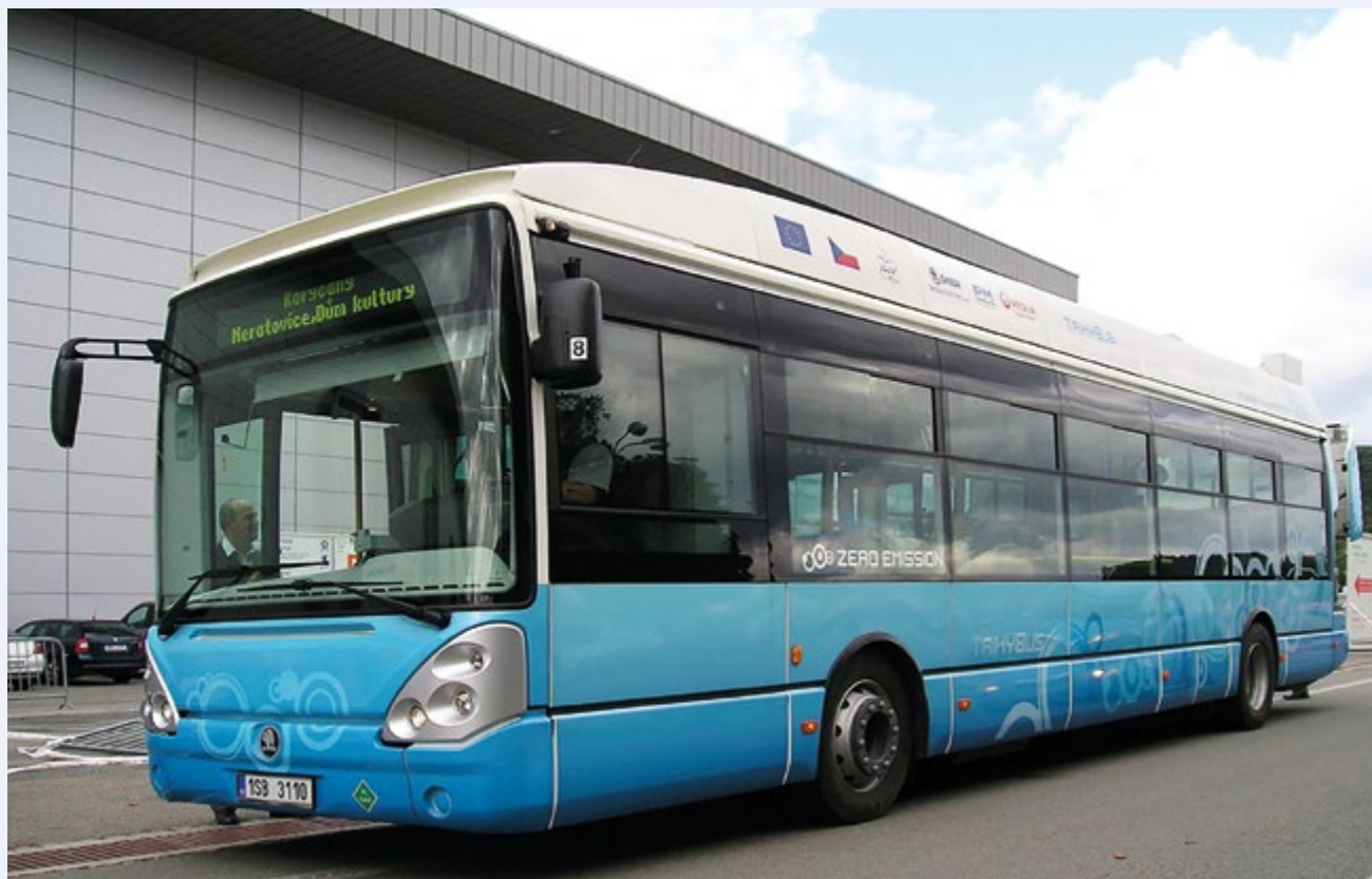
Hybridní autobus s pohonem využívajícím vodíkový palivový článěk
