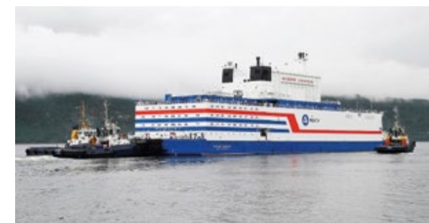
Akademik Lomonosov - plovoucí ruská jaderná elektrárna se dvěma malými (modulárními) jadernými reaktory
