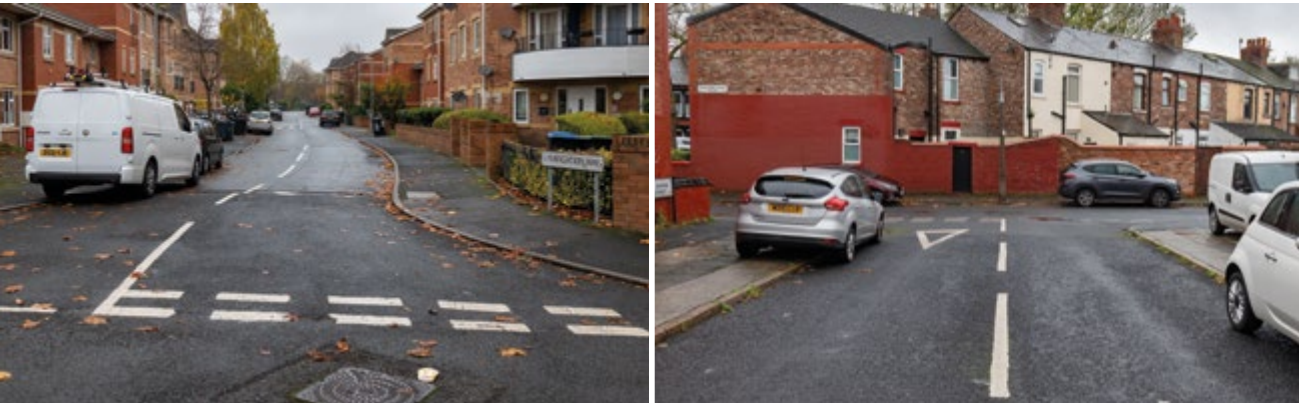
Přednost v jízdě je vyznačována primárně VDZ, SDZ se obvykle nepoužívá (Velká Británie)
