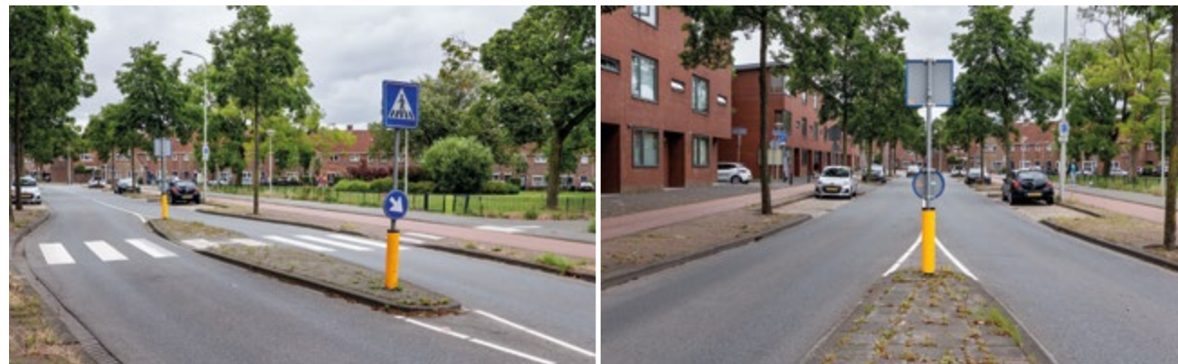
Dostatečný rozhled z ostrůvku s delšími náběhy (Nizozemsko)
