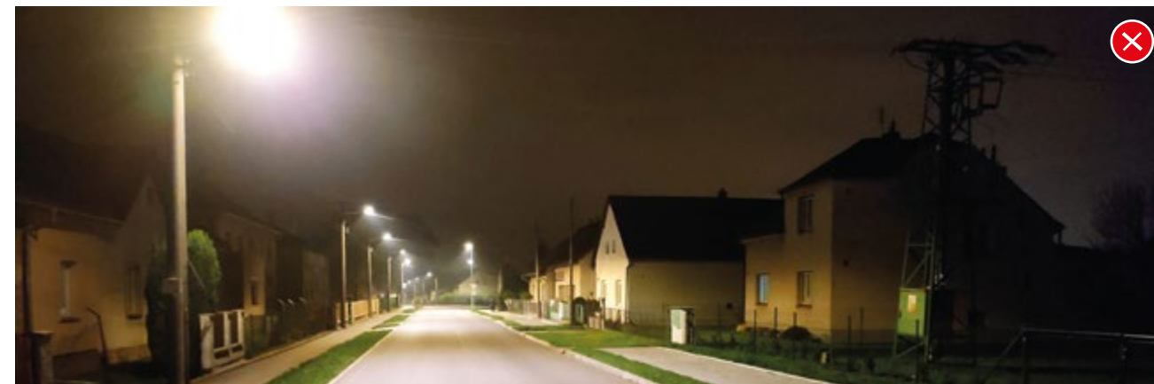
Svítidla umístěná na sloupech vysokých 8–10 m často šíří světlo nejen do oken okolních domů, ale v nízké zástavbě i přes střechy do okolní krajiny. Pro menší obce a obytnou zástavbu jsou taková svítidla velmi nevhodná.
