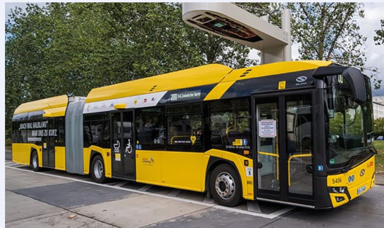
Berlínský elektrobus s dobíjením invertovaným pantografem OppCharge na pravidelné lince
