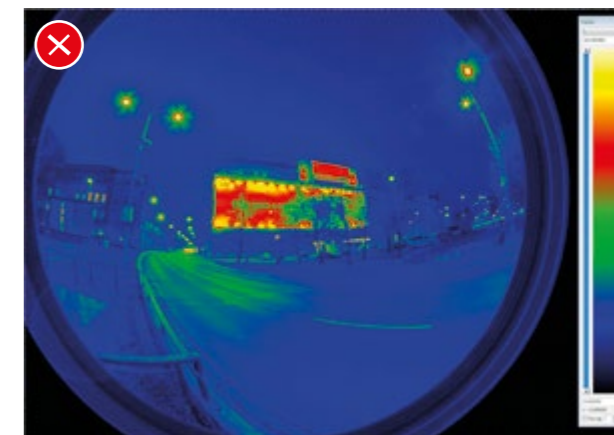
Data z jasové kamery dokládají lokální extrémy u reflektorů na billboardu, který byl předmětem oficiálních stížností občanů, jejichž byty byly rušeny tímto světlem až na stovky metrů a bylo dosaženo zrušení této instalace (Nuselský most, Praha)
