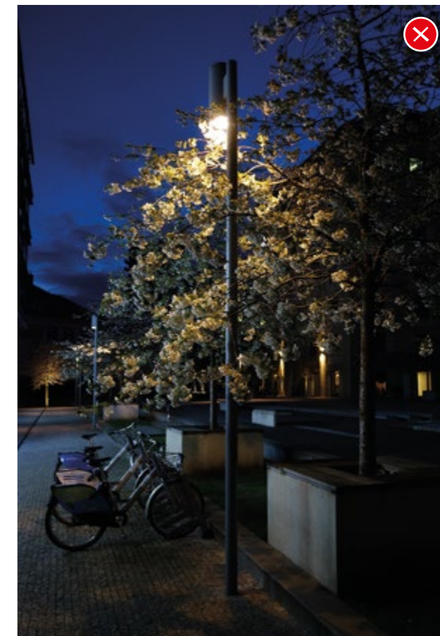
Pozice sloupových svítidel ve vyšších výškách v blízkosti stromů obvykle koliduje s jejich korunami a chodník zůstává ve tmě
