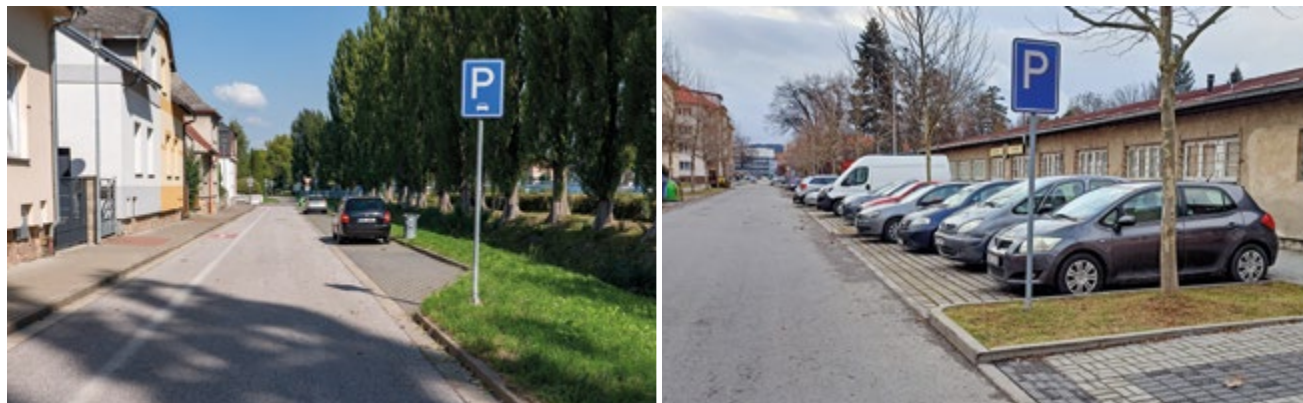
Zbytečně osazená značka vyznačuje zřejmě plochy parkování
