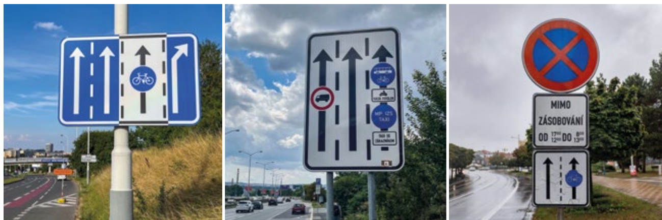
Zmenšená značka IP 19 na sběrné komunikaci v nestísňených poměrech
